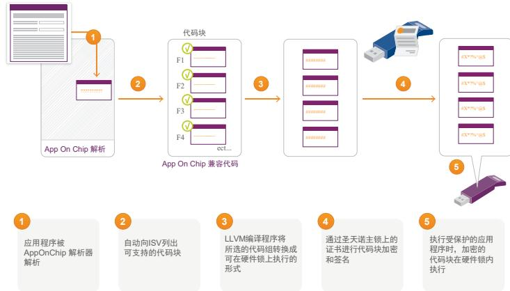
**执行：** 最终用户准备使用软件时，执行阶段就会启动。受保护的软件会正常执行，直至达到圣天诺LDK中的AppOnChip所保护的功能。应用程序中部分代码将传输给硬件锁。
